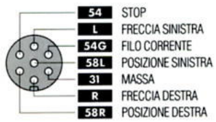
- Schema impianto elettrico per presa e spina
