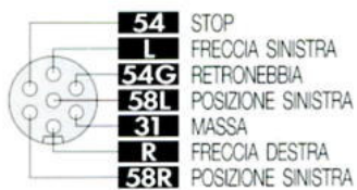
- Schema impianto elettrico per presa e spina
